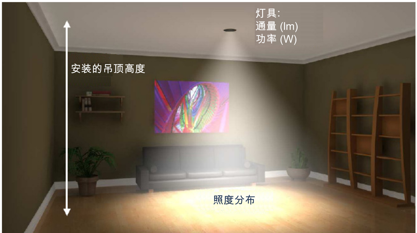
图 1: 示例 CFL 筒灯的关键特征
