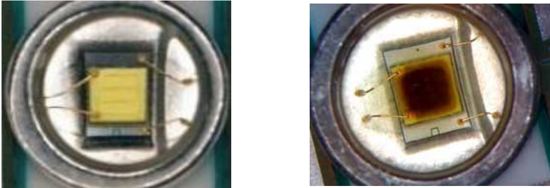
图6: 正常LED (左) 和因VOC降级后的LED (右) 示例
